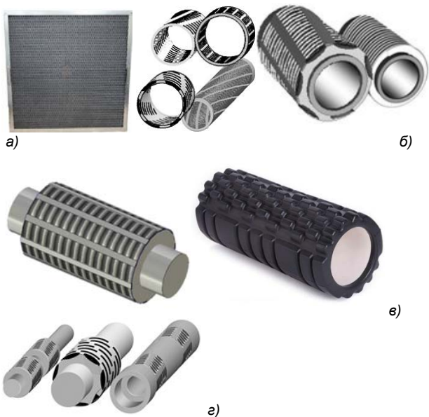
Рис. 1. Детали со сквозной и глухой дискретно- щелевой структурой. а) фильтрующие элементы, б) оребренные трубы теплообменников, в) фигурные валки, г) плунжеры и валы с оребрением под покрытие.
